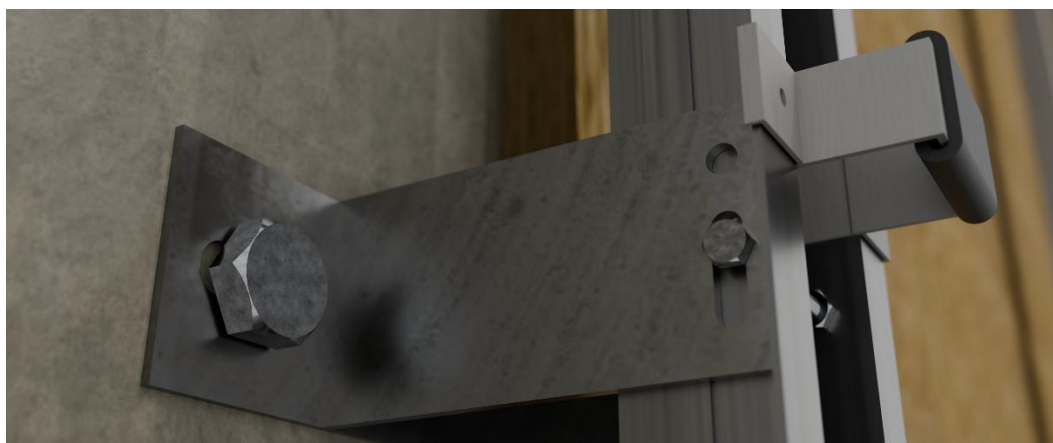
Figure 6 : Fixation des profilés oméga dans les étriers double T
