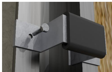
Figure 8 : Coulisseau - Vue 3D assemblé
